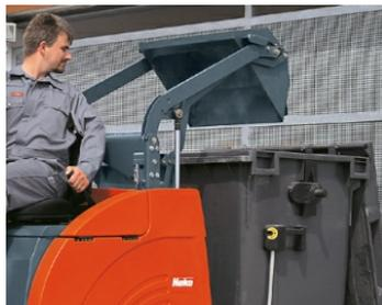
**Vidage en hauteur tout confort :** le bac à déchets peut être vidé directement en hauteur dans une benne standard (option).
