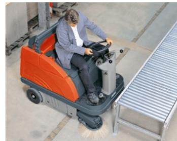
**Maniabilité :** diamètre de braquage réduit permettant de manœuvrer même dans les espaces les plus exigus, grâce à un angle de braquage de 90°.
