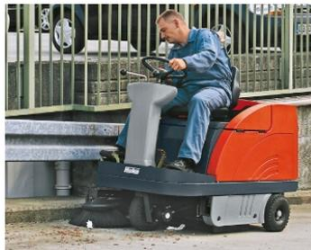
**Sécurité au travail maximale :** conduite et arrêt en toute sécurité même sur des rampes : aptitude en côte jusqu'à 16 % selon le modèle.
