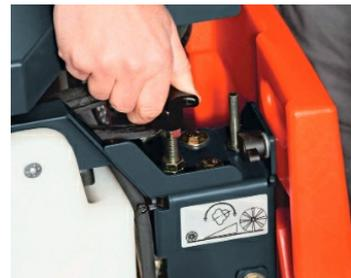
**Compensation de l'usure en toute simplicité :** grâce au système ABBA, le rouleau de balayage principal peut être réglé de sorte à garantir un balayage toujours parfait sur toute sa durée de vie.
