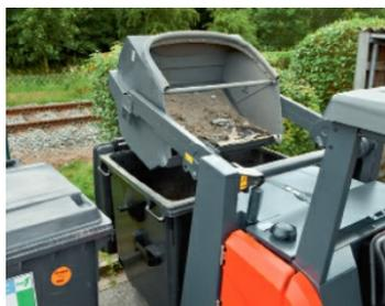
**Système de vidage du bac à déchets hydraulique :** Le bac à déchets totalement exploitable peut être vidé à une hauteur jusqu'à 1,42 m.
