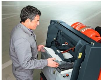
**Grande autonomie et pas de rejet de poussières :** système de filtre à cartouche avec grande surface de séparation et technologie de nettoyage de filtre brevetée R<sup>2</sup>S.
